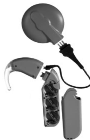
**Рис. 3.** Основные компоненты сигнального процессора MED-EL OPUS2
